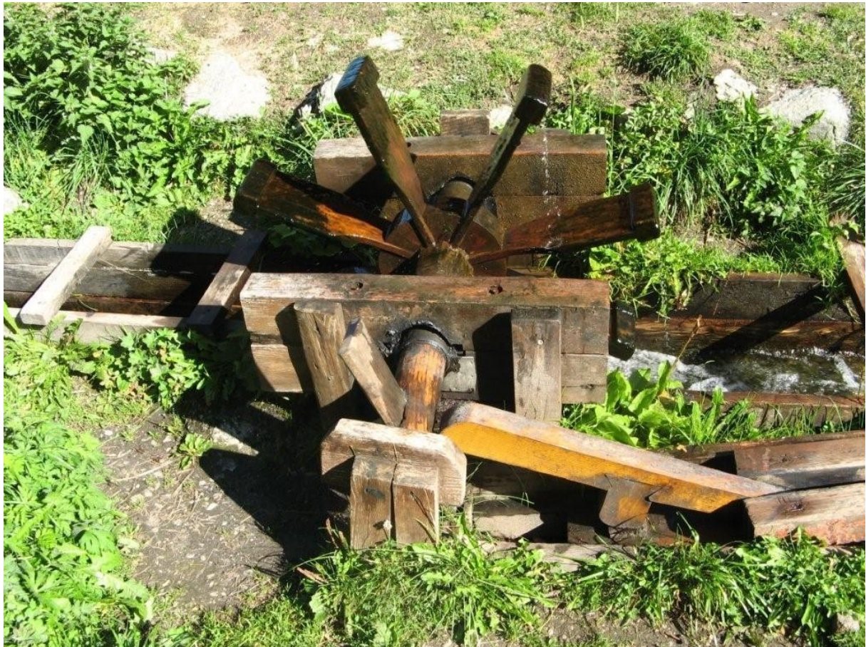
Fig : automatisme annonçant la réduction du débit dans un buis (Valais en Suisse). La roue entraînait un marteau dont la réduction de la cadence de frappe, sinon même l'arrêt, prévenait qu'un problème existait sur le béal en amont (rupture, prise colmatée, vol d'eau etc )
