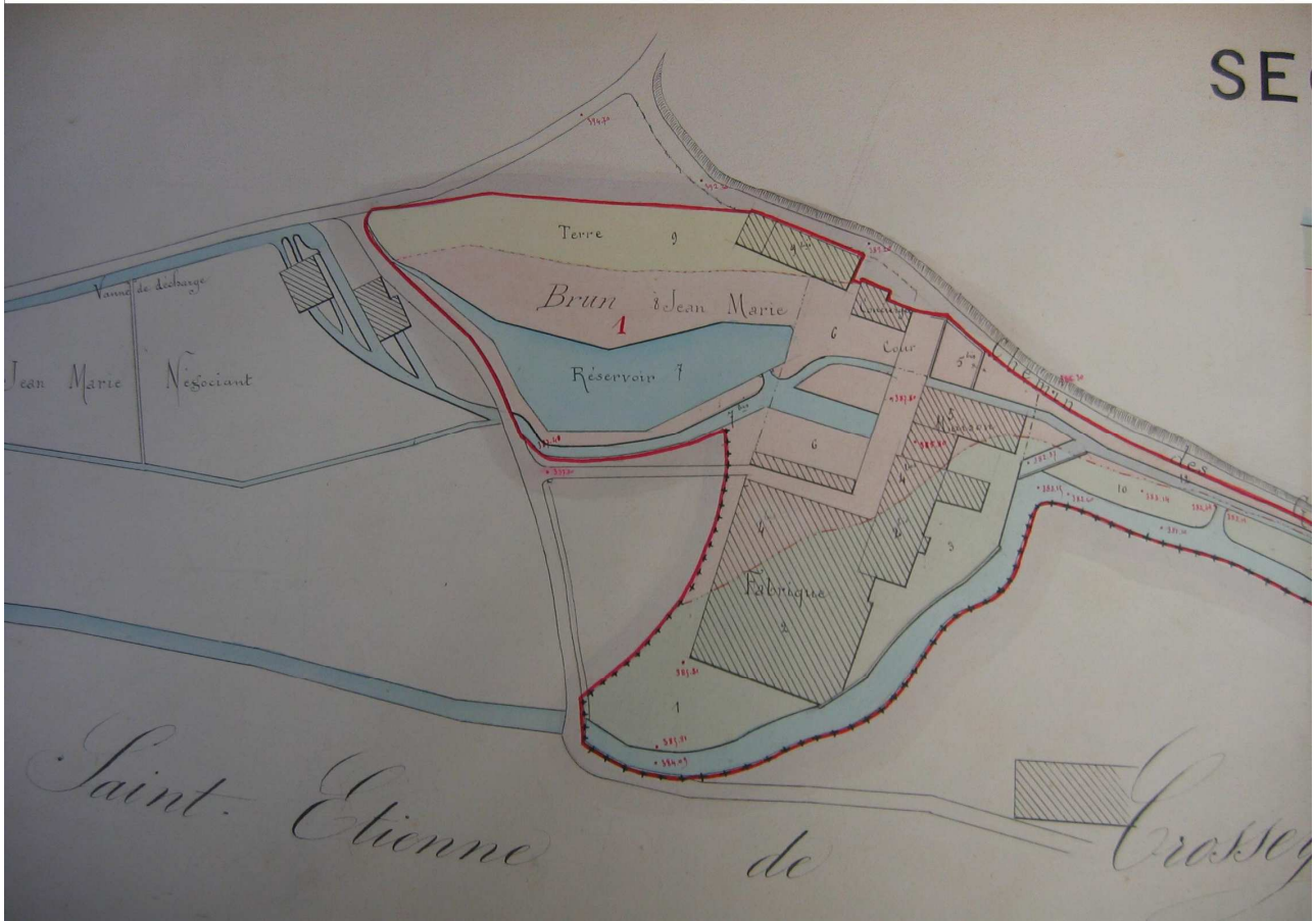
Fig : plan de 1902 : la soierie Brun avec les béals et la serve . Image avec le nord vers le bas et avec la Morge qui coule de la gauche vers la droite !!!
